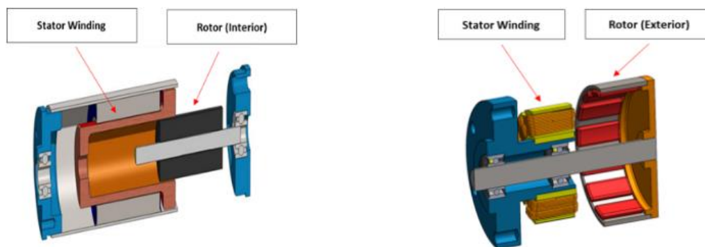
Figure 2-6 : Machines à rotor interne et externe [4]
