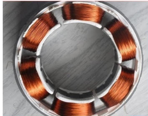
Figure 6-9 : Image d'un bobinage distribué (gauche) et concentrique (droite) [10]
