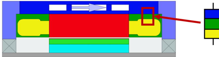
Figure 7-14 : Vue axiale sur le potting des têtes de bobines
